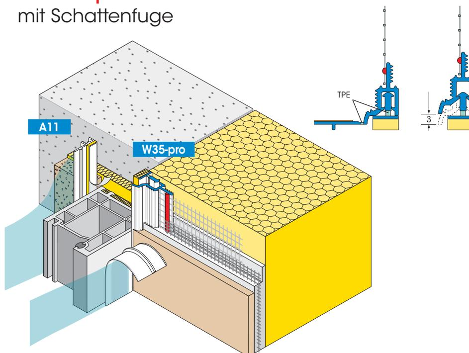
Die Teleskop-Gewebeleiste FLEX-pro ist für WDV-Systeme vorgesehen mit tiefer Laibungsdämmung, Dämmstärken bis 160 mm und mauerwerksbündig eingebauten Fenstern. Durch die zwei ineinander gesteckten Profile ist die Gewebeleiste horizontal und vertikal beweglich. Der flexible Steg bewegt sich zusätzlich vor und zurück. Dadurch lassen sich Ausdehnungen im Anschlussbereich zwischen Putz und Rahmen ausgleichen.
