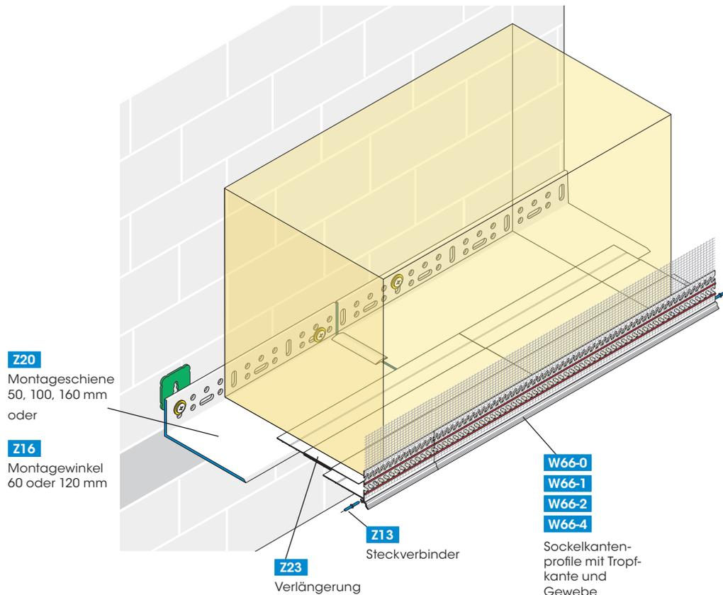
Die APU-Verlängerung Z23 aus Kunststoff erweitert die Ausladung der APU-Sockelkantenprofile W66 um 30 bis 50 mm. In Kombination mit dem Sockelkantenprofil W66, zwei Verlängerungen Z23 und der Sockelschiene Z20-160 mm sind damit Dämmstärken bis 300 mm möglich.
