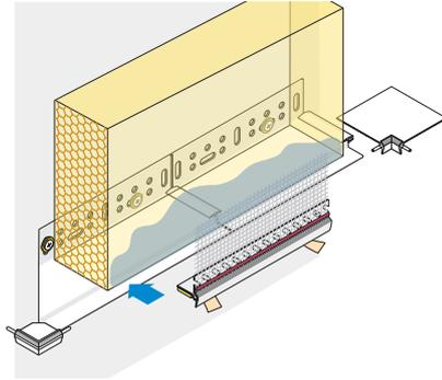
Zum Ausrichten der Gewebeleisten/Abschlussprofile werden 5 cm lange Anfasstreifen des Abdeckbandes vor das Abschlussprofil W60 gezogen, danach erfolgt das Ausrichten gemäss der Dämmung: Abschlussprofil unter die Dämmplatte schieben (Stoss zwischen Sockelschienen überlappend verarbeiten). Abdeckband an den Laschen komplett herausziehen, Abschlussprofil und Sockelschiene auf der ganzen Länge gegeneinander drücken.
