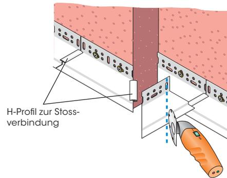
Mit Hilfe eines **Multimaster-Werkzeugs (Marke FEIN)** Eckteile am Montageort passgerecht zuschneiden.
