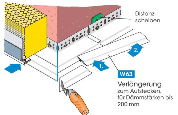
Verlängerung in gleicher Weise zuschneiden und in fertig montierte Sockelschiene einclippen (zuerst ein Ende einclippen, dann die Verlängerung zum anderen Ende hin in Position drücken - siehe Grafik - erleichtert die Arbeit).
