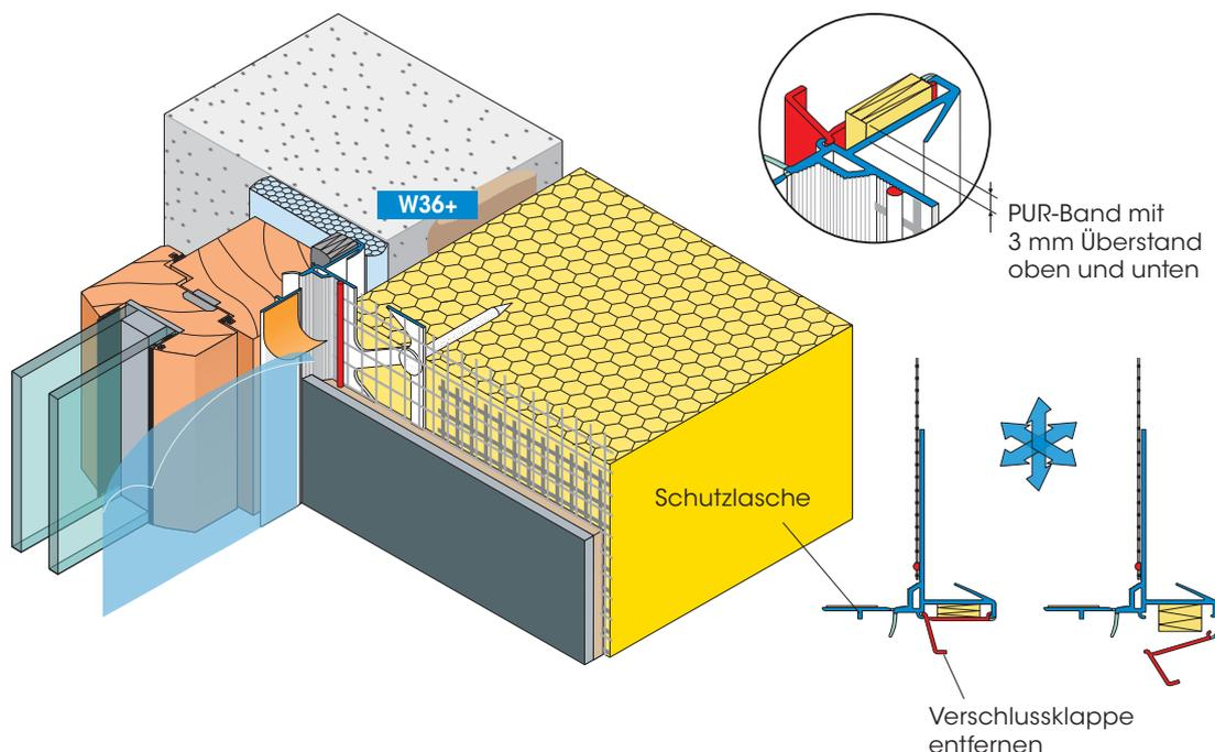
Die Gewebeleiste NEO-plus wird eingesetzt bei Putzanschlüssen im WDVS, bei denen mit grösseren Ausgleichsbewegungen gerechnet werden muss und wenn eine Verklebung auf dem Fensterrahmen nicht möglich oder nicht gewollt ist.
