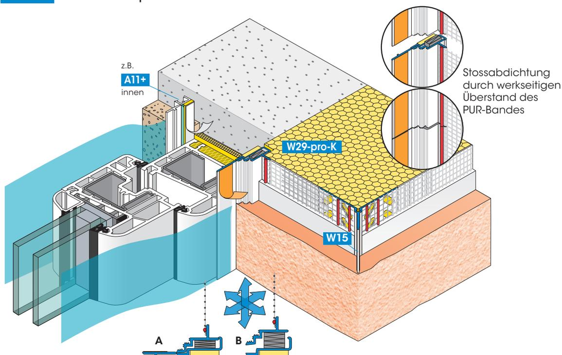
Die APU-Gewebeleiste PUR-EX-pro-K ist mit einem komprimierten, eingestauchten Polyurethan-Band ausgestattet (A), welches durch Entfernen der Schutzlasche ausgelöst wird und nach den Anforderungen frei expandiert (B). Es entsteht eine **entkoppelte Lösung** (\*) zwischen Putzsystem und Rahmenkonstruktion.
