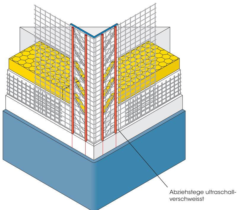
Ein Eckwinkel der neuen Generation aus Kunststoff, mit grossen Langlöchern für die gute Durchlassfähigkeit der Beschichtungsmasse.
